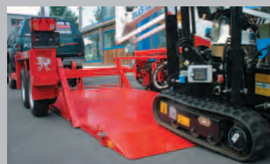
Die ganze Plattformbreite ersetzt die Rampe; d.h. der geringe Steigungswinkel ermöglicht auch das Auffahren von Fahrzeugen mit geringer Bodenfreiheit.
