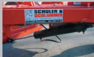
Der Hebezyylinder ist unter der Deichsel geschützt und direkt auf die Plattform wirkend.
