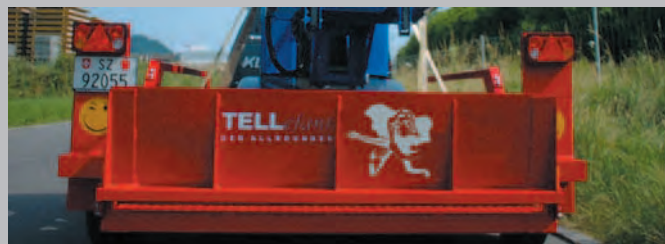
Als Unterfahrschutz modifizierte Klapprampe
