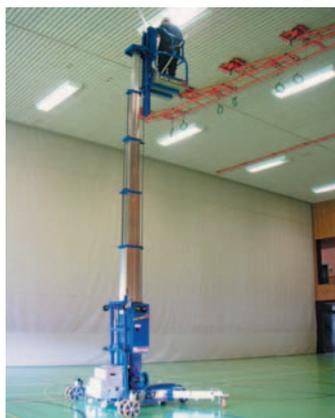
Le You Drive se déplace à hauteur maximale d'un endroit à l'autre à l'aide de instruments installés dans sa nacelle.
